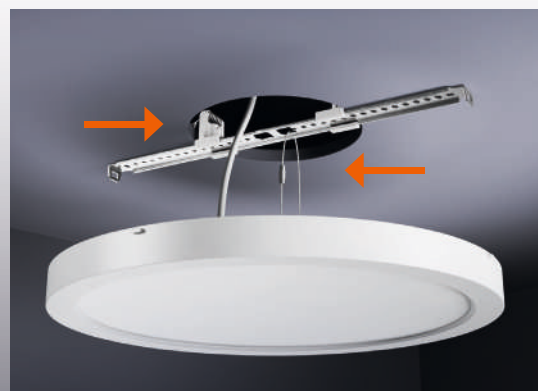
Prenda a luminária usando o cabo de segurança, conecte-a à fonte de alimentação e encaixe-a na calha.
