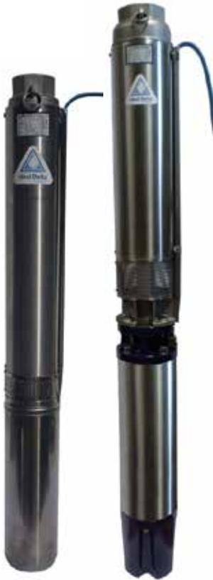
Eletrobombas Submersíveis Delta são bombas centrífugas multiestágio, submersíveis, e adequadas para aplicação em furos artesanais ou poços. Estas bombas podem ser utilizadas para captação, pressurização e distribuição de água numa vasta gama de aplicações domésticas, agrícolas ou industriais. Com alturas manométricas até 295 m.c.a., caudais até 41 m<sup>3</sup>/h e saídas de 1.1/4", 2" e 3".
