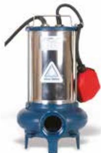
As eletrobombas submersíveis de drenagem do tipo SP são bombas centrífugas, submersíveis, de elevada robustez e fiabilidade. Estas bombas podem ser utilizadas para drenagem, elevação e transferência de águas pluviais, águas limpas de esgoto e de infiltrações nas mais variadas aplicações domésticas, agrícolas, comerciais ou industriais. Com alturas manométricas até 40 m.c.a., caudais até 32 m<sup>3</sup>/h e saídas de 1.1/4", 1.1/2", 2" e 2.1/2".
